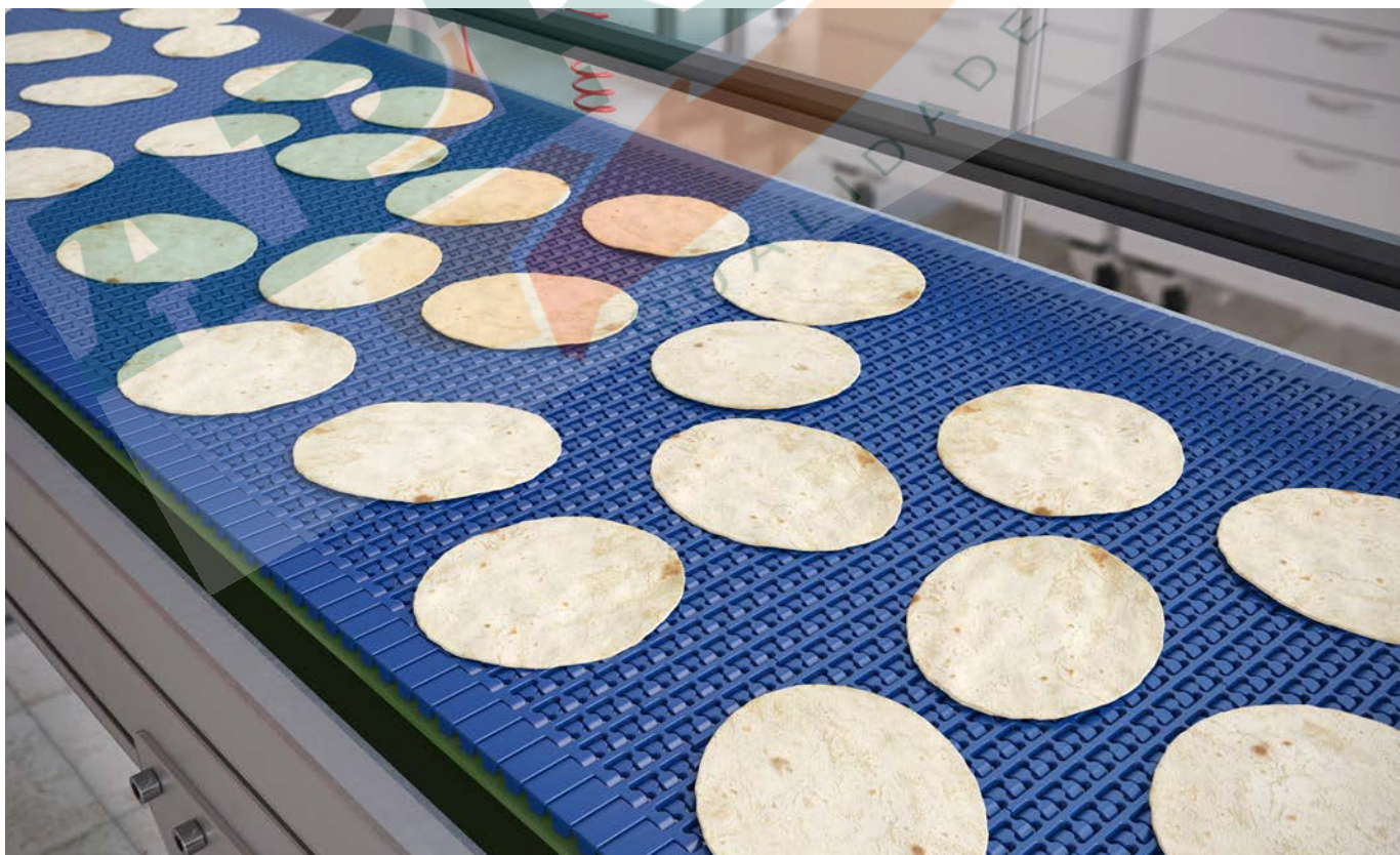
Sistema trasportatore dotato di Catena KleanTop Rexnord Serie 596.
