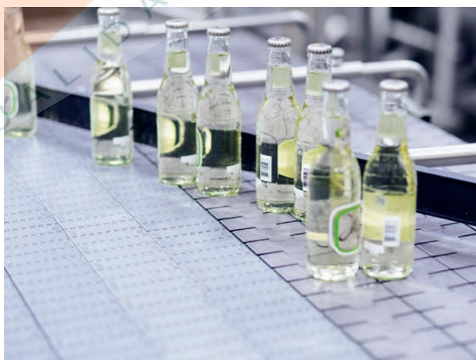
Trasportatore di bottiglie con nastro FTDP1000 XLG
