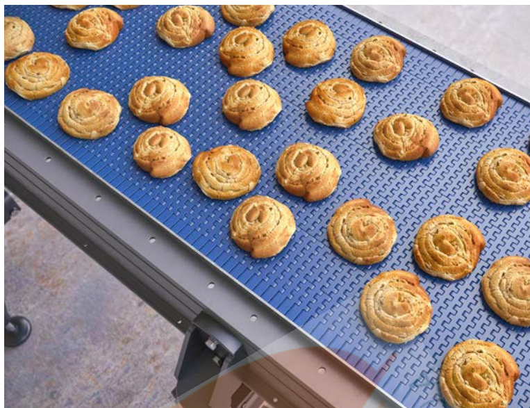
Sistema trasportatore dotato di Catena KleanTop Rexnord Serie 595.
